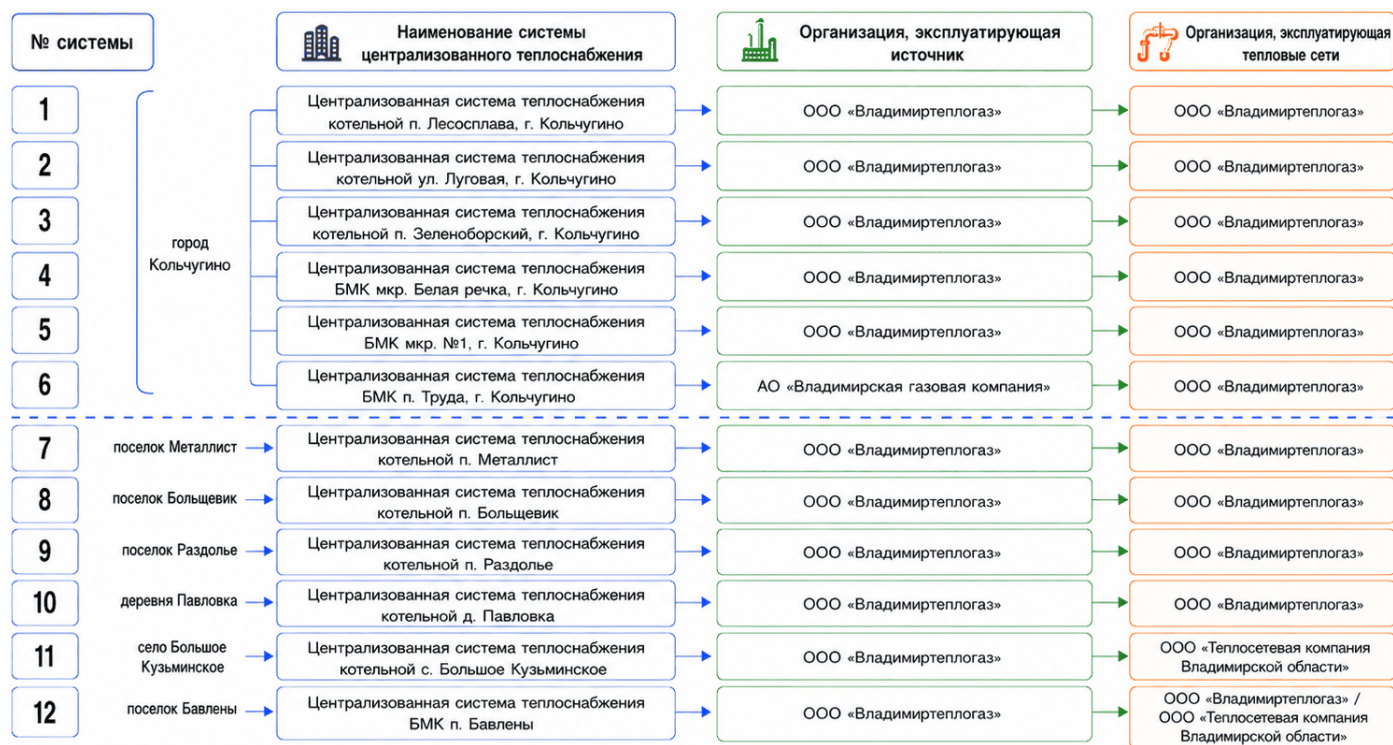
Рисунок 1.1.1 - Функциональная структура систем теплоснабжения Кольчугинского муниципального округа
